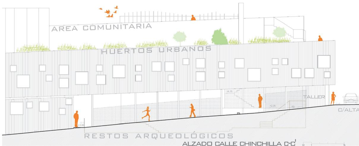
Por otro lado, la organización general del edificio en forma de bandas nos permite optimizar el sistema estructural, tanto en lo referente a la disposición de la estructura (luces y elementos de dimensiones similares, sistemas continuos), como a los sistemas empleados (estructura metálica, forjados de chapa metálica colaborante), que permiten una ejecución sencilla, rápida y económica.
