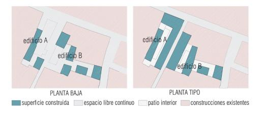
Dada la geometría de la superficie de actuación, y en la búsqueda de ventilación cruzada de todas las viviendas, se plantea en ambos edificios sendas secuencias de bandas de patios y edificación (figura 6).
