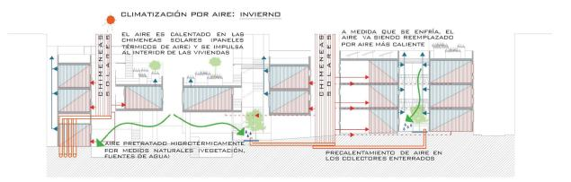
De esta manera, evitamos el uso de materiales refrigerantes contaminantes (CFC o similares), ya que el sistema de climatización es 100% natural. Además reducimos prácticamente a cero el consumo de energía para climatización, sólo usamos la necesaria para hacer funcionar los ventiladores (en chimeneas y en colectores enterrados) necesarios para garantizar la circulación de aire.
